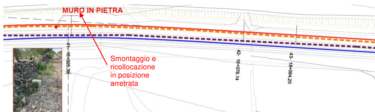
Stralcio elaborato DAR_3DV011a di Progetto Definitivo con evidenza della soluzione adottata in fase di realizzazione in linea con le indicazioni di cui alla Nota 2948/21
